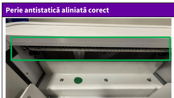
Figura 1: Perie antistatică aliniată corect
